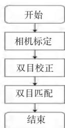
图4 双目测距流程图
